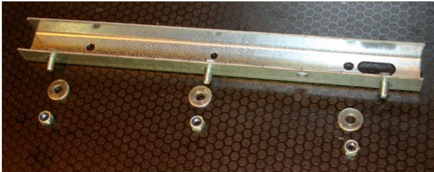
KUVA 1 : Kuomun saranan kiinnityslevy + kiinnitystarvikkeet (Ruuvit M10x20, mutterit ja aluslevyt M10)
