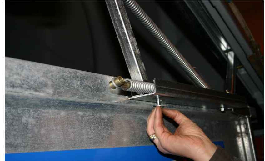
KUVAT 8 & 9 : Kiinnitä kuomu saranoinnista kärryn laidoissa oleviin kiinnitysrautoihin kuvassa 6 irrotetuilla osilla (kiintoavain / hylsy 13mm).
