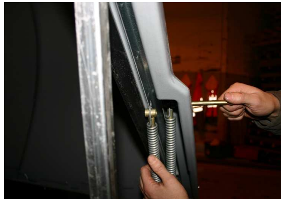
KUVA 11 : Vedä tappi ulos niin paljon, että kierrejouset mahtuvat asettumaan kuomun kouruun (toinen sinkityn U-kourun sisään toinen ulkopuolelle).
