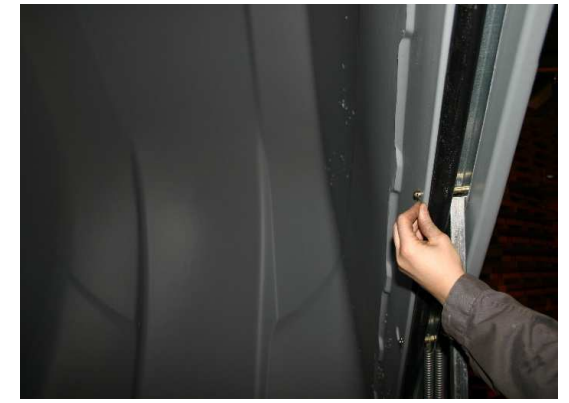
KUVA 12 : Työnnä tappi saranan holkkien läpi pohjaan asti ja kiinnitä sokka kuomun sisäpuolelle. Irrota tässä vaiheessa myös neljän muun tapin sokat ja työnnä tapit pohjaan ja kiinnitä sokat kuomun sisäpuolelta. (Huom! Sokat ovat kuljetuksen takia kuomun saranointiurassa)
