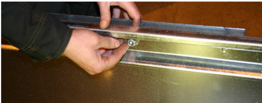
KUVAT 2 & 3 : Kiinnitä kuomun saranan kiinnityslevy perävaunun sivulaitaan (etupäähän) kuvan mukaisesti. (Kiintoavain 17mm + räikkäväännin ja hylsy 17mm)
