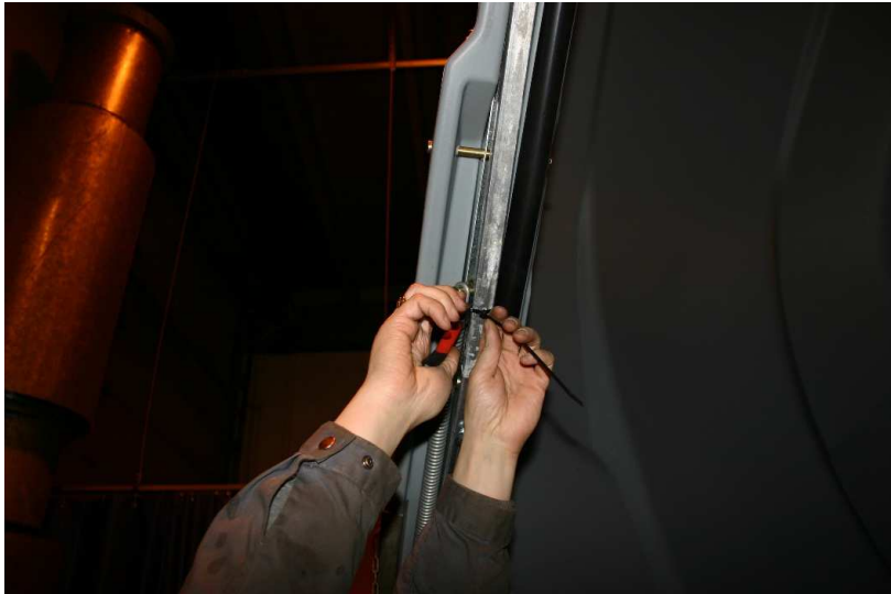
KUVA 5 : Vapauta kuomun saranapaketit poistamalla nippusiteet
