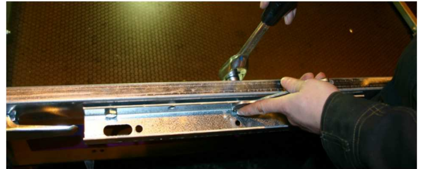
KUVA 2 & 3 : Kiinnitä kuomun saranan kiinnityslevy perävaunun sivulaitaan (etupäähän) kuvan mukaisesti. (Kiintoavain 17mm + räikkäväännin ja hylsy 17mm)
