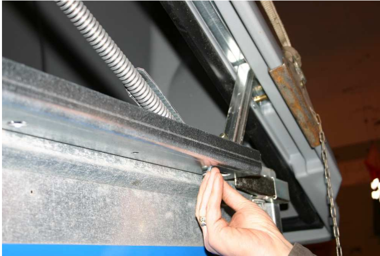
KUVAT 8 & 9 : Kiinnitä kuomu saranoinnista kärryn laidoissa oleviin kiinnitysrautoihin kuvassa 6 irrotetuilla osilla (kiintoavain / hylsy 13mm).
