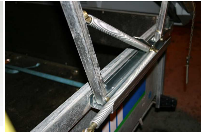
KUVA 6 : Irrota U-kourun pohjassa olevat pultit ja prikät (M8), 2kpl /puoli (kiintoavain / hylsy 13mm)
