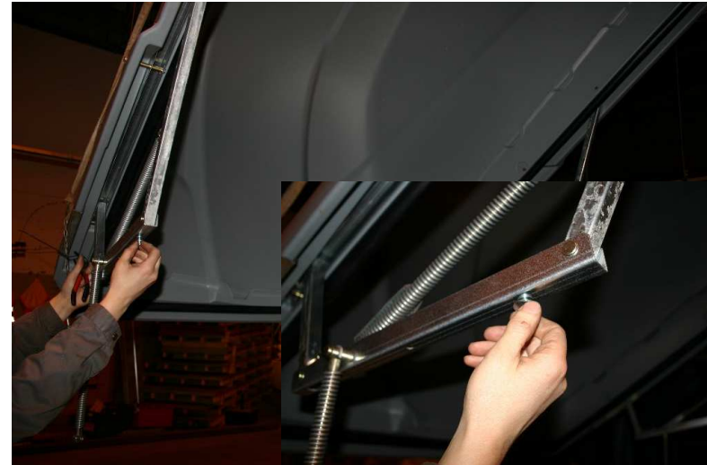
KUVA 6 : Irrota U-kourun pohjassa olevat pultit ja prikät (M8), 2kpl /puoli (kiintoavain / hylsy 13mm)
